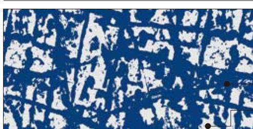
●工程例／希望するカラーステンレスの板にエッティングと同様の工程で希望する柄を印刷し光沢電解槽で電解処理します。カラー部分の色が落ちると共に生地面に光沢感を与えます。その後インクを洗浄すると、カラー部分と光沢感を持った生地色の2色の柄が表現できます。表面には少し凸凹感がでます。
