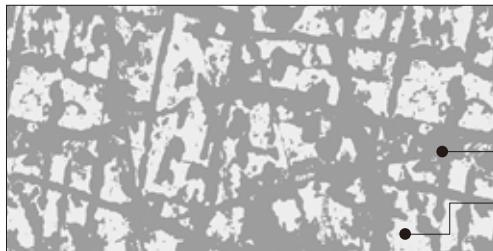
●工程例／希望する柄のシルクスクリーンを作り、選んだ表面仕上げのステンレス板の上に、柄を耐酸インクで印刷します。次に塩化第2鉄（ステンレスを溶かす液）を噴霧する装置に、ステンレス板を通します。ここでインクを施した以外の部分がエッティング（腐蝕）で削られ、柄が出ます。その後インクを洗浄し、乾燥。表面には、凸凹感がでます。
