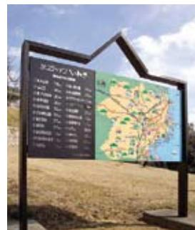
当社があるいわき市の観光案内板です。フレームと名称表示板にスーパーブラックを使い、観光地名称の文字は光沢エッディングで表現されています。フレームは角パイプ溶接による一体成形品ですが、スーパーブラックが均一に着色されています。(地図部分は印刷シートです)
