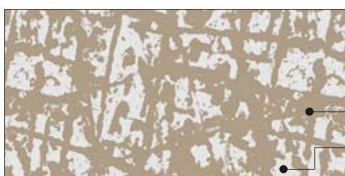
●工程例／希望する柄のシルクスクリーンを作り、カラーステンレスの上に、柄を耐酸インクで印刷します。次に脱色槽に浸漬し、インクが施された以外の部分の色を落とします。その後インクを洗浄、乾燥すると、ほとんど凸凹感なく、カラー部分と生地色の2色の柄が表現できます。
